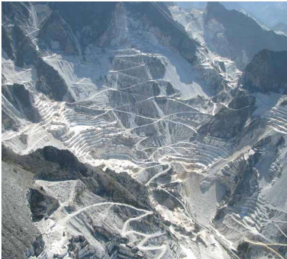
Figura 2. Il bacino estrattivo di Carrara visto da Foce Pianza. Sono evidenti le strade d'arrocamento e le pareti di cava (foto: D. Capra, 2016).
